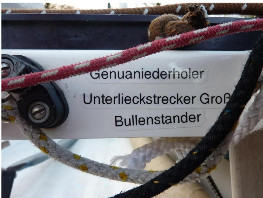
Unterlieckstrecker (Travellerschiene vorn, mittlere Klemme, rot-weiße Leine, an Backbord und Steuerbord) durchsetzen
